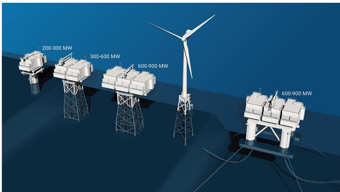
Rysunek 4. Przykłady stacji transformatorowych oraz różnych typów fundamentów (Dodd, 2017).
