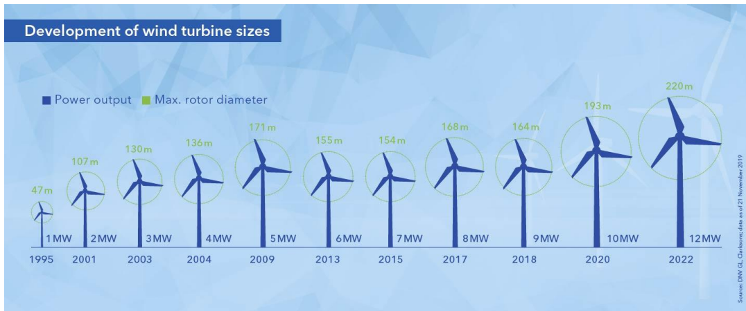
Rysunek 3. Rozwój rozmiaru i mocy elektrowni wiatrowych w latach 1995-2022 (DNV). W roku 2023 odnotowywano elektrownie na poziomie 15 MW.
