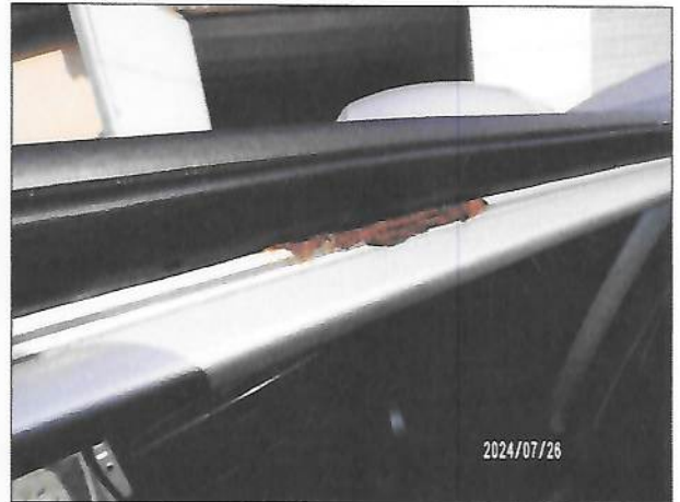
Komora bagażnika i widok skorodowanej ramy drzwi tylnych lewych
