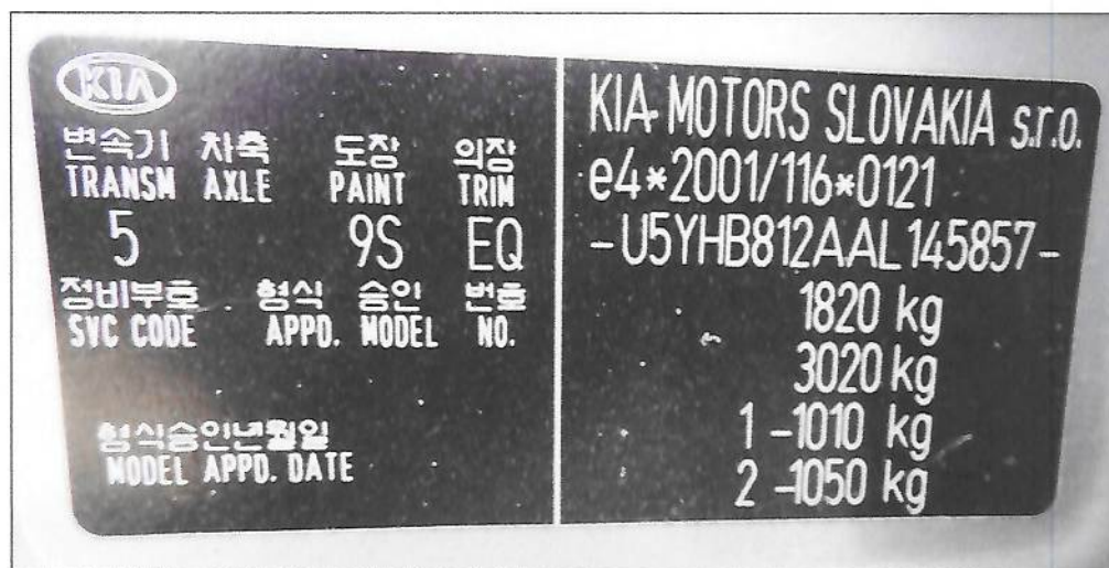
Cecha identyfikacyjna (numer VIN) i dane fabryczne producenta na tabliczce znamionowej
