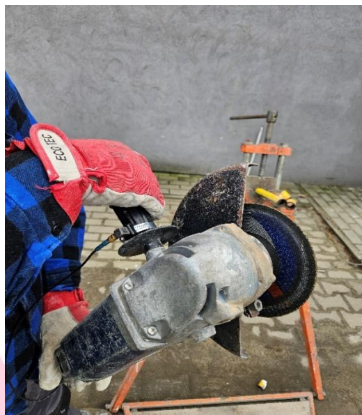
Zdjęcie 5. Badania czynników fizycznych w środowisku pracy – mikroklimat, drgania miejscowe.
