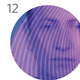
Mikrodruk widoczny w promieniowaniu UV Microprints visible in UV light
