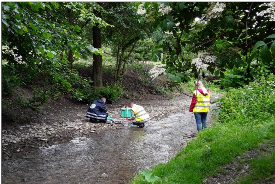
Zdjęcie 5. Pobór wód do badań z ciekę wodnego Zawadka poniżej i powyżej miejsca stosowania nawozów oraz miejsca przechowywania nawozów naturalnych miejscowości Zawada
