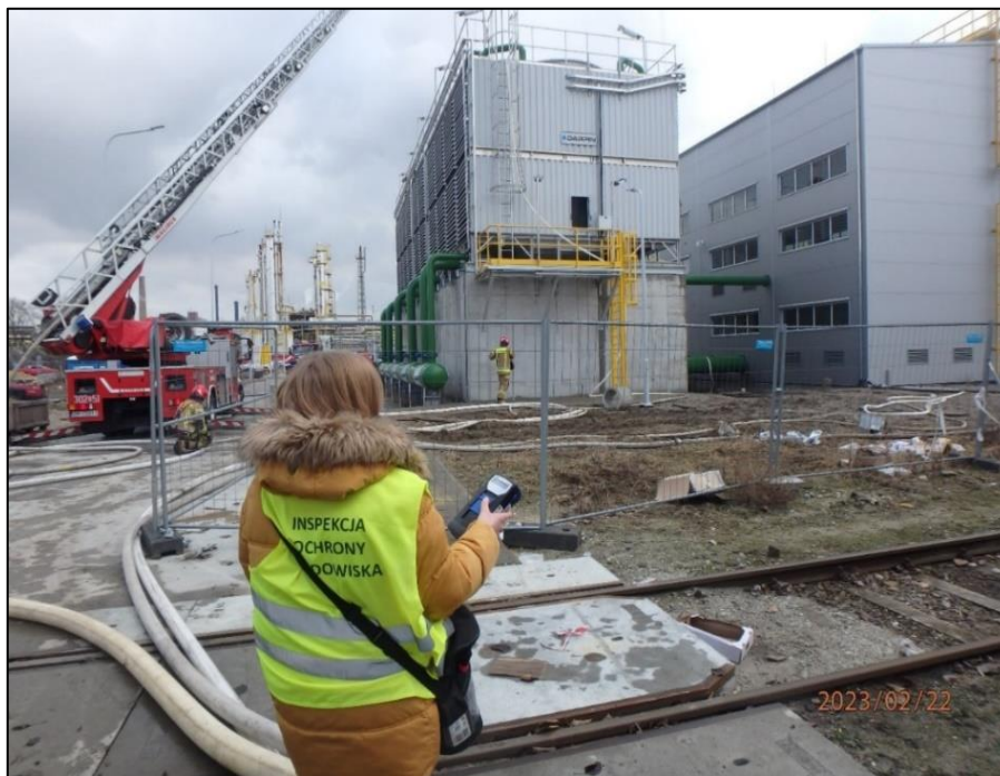
Zdjęcie 3. Pomiar na obecność toksycznych substancji w powietrzu przy użyciu mobilnego detektora wielogazowego Dräger po pożarze chłodni kominowej na terenie zakładu zlokalizowanego w Kędzierzynie – Koźlu
