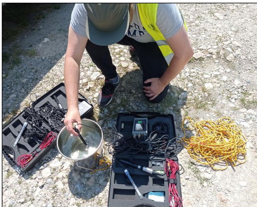
Zdjęcie 1. Badania wstępne próby wody z Kanalu Gliwickiego za pomocą przyrządu wielofunkcyjnego do terenowych pomiarów wody
