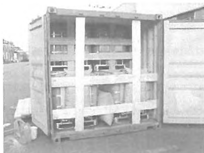
Rys. 15. Pojemniki do przewozu masowych ładunków niebezpiecznych (IBC) zasztauowane w dwóch warstwach w kontenerze
