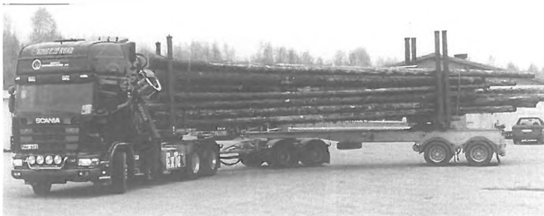
Rys. 82. Przewóz drewna długiego (jest to pojazd specjalnego przeznaczenia niespełniający wymogów dyrektywy 96/53/WE)
