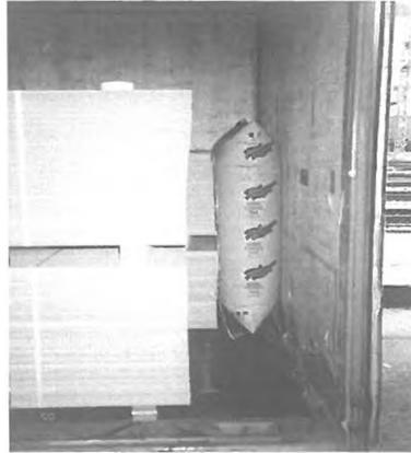
Rys. 19. Poduszka powietrzna w naczepie
