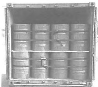
Rys. 89. Beczki luzem w dwóch warstwach i czterech rzędach w kontenerze
