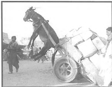
Rys. 5: Nieprawidłowy rozkład obciążenia. Może to być zabawne... albo mieć poważne konsekwencje.
