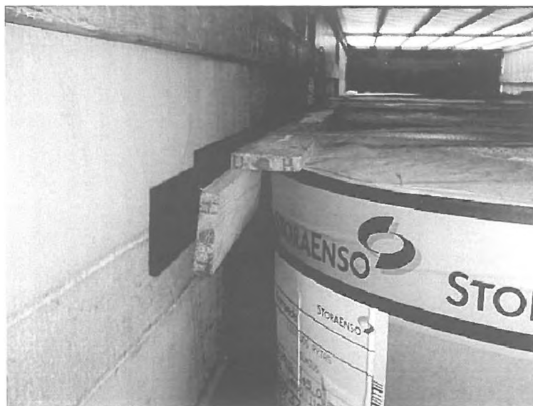
53. Listwa kątowa wykonana z desek drewnianych
