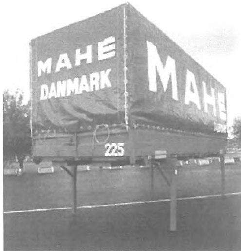
Rys. 16: Nadwozie wymienne stojące na podporach
