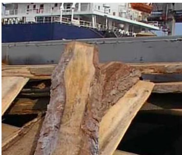
Zdjęcie 6 – Kora przekraczająca granice tolerancji. To drewno sztauerskie nie spełnia wymagań.
