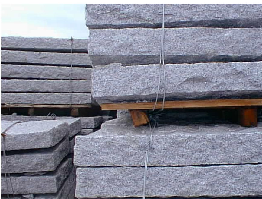
Zdjęcie 5 – Materiał sztauerski używany do transportu kamienia
