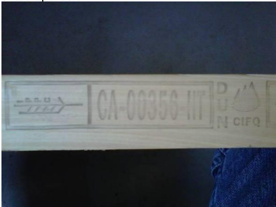
Ilustracja 1 5 – Oznaczenie odpowiada przykładowi 6 w załączniku 2 do ISPM 15. Dodatkowe informacje podano poza obramowaniem oznaczenia.
