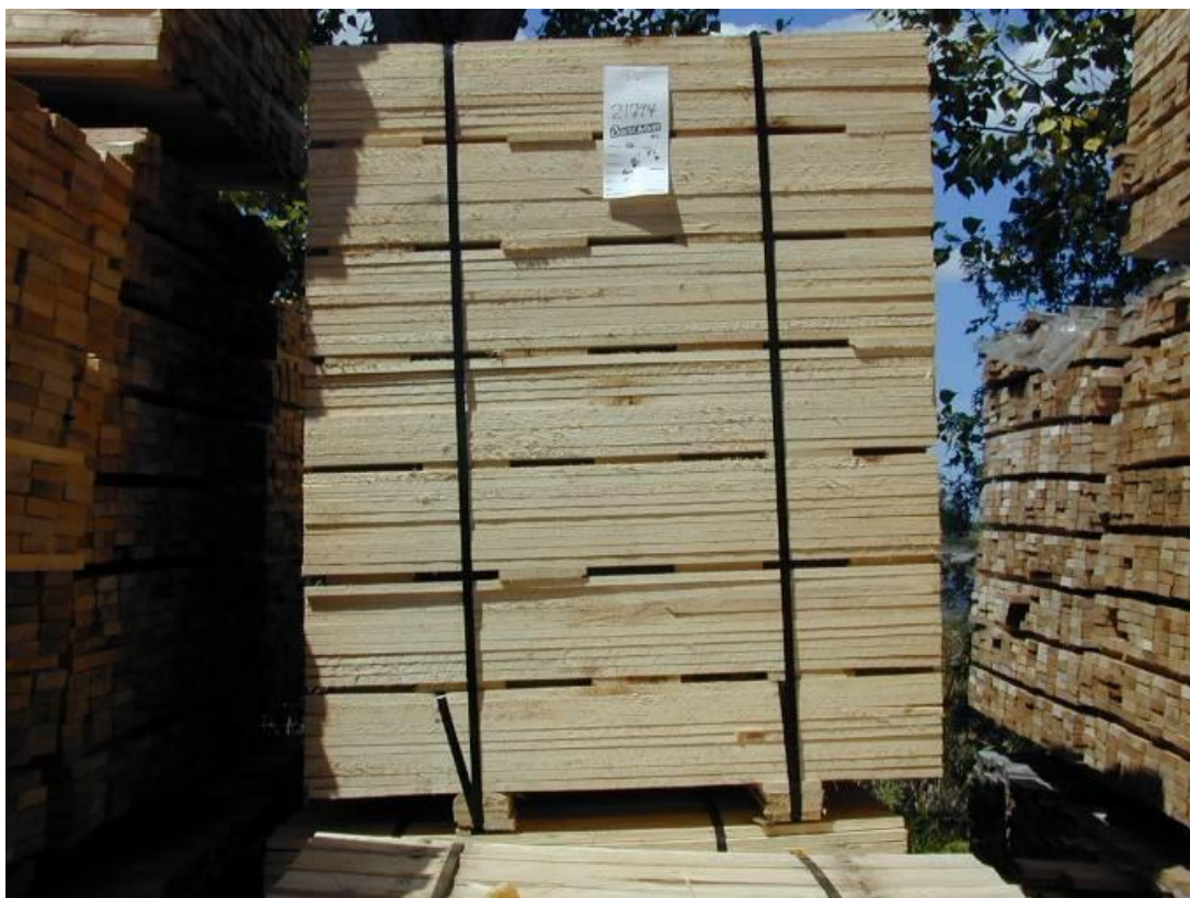
Zdjęcie 2 – Materiał sztauerski stosowany przy transporcie przetartego drewna
