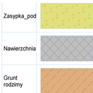
Rys. 4.3.1.3.1. Parametry materiałowe przyjętych warstw w modelu obliczeniowym
