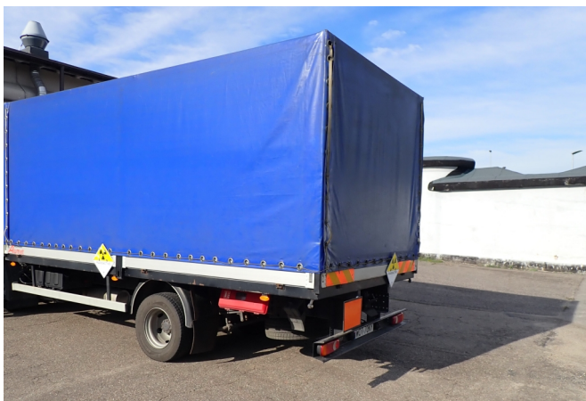
Rys. 5. Oznakowanie pojazdu transportującego odpady promieniotwórcze (źródło własne).
