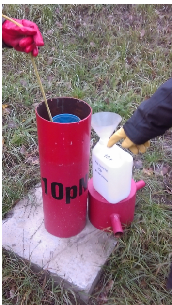
Rys. 4. Piezometr 10 pN z terenu KSOP. Fig. 4. 10pN piezometer from the NRWR site.
