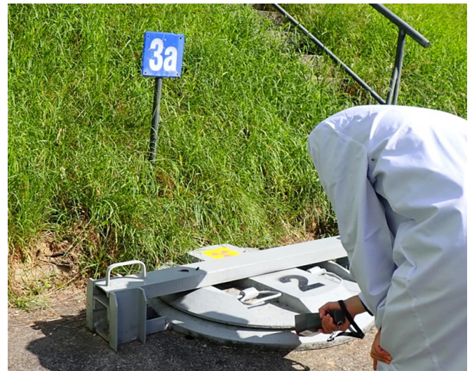
Rys. 11. Pomiar mocy dawki na powierzchni włazu obiektu do składowania zużytych zamkniętych źródeł promieniotwórczych (źródło własne).
