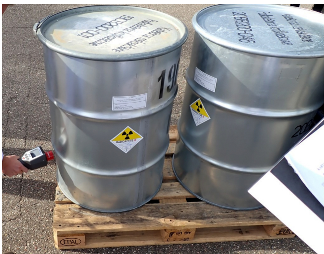
Rys. 6. Pomiary mocy dawki na powierzchni pojemników (źródło własne).
