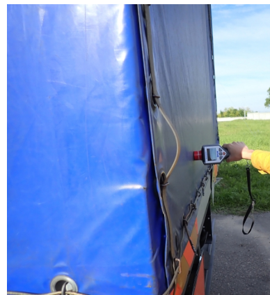
Rys. 4. Pomiar mocy dawki przy pojeździe transportującym odpady promieniotwórcze (źródło własne).
