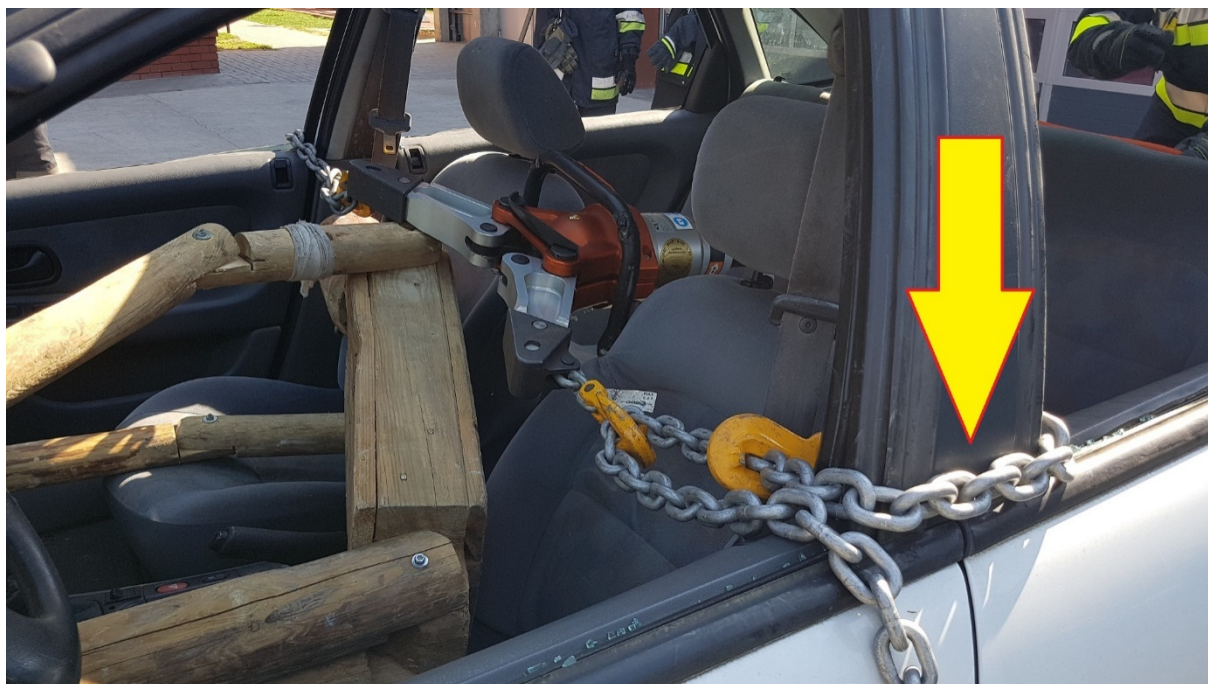
Rys. 469. Krok 1: montowanie łańcucha od zgniatanej strony, na wysokości poszycia drzwi
