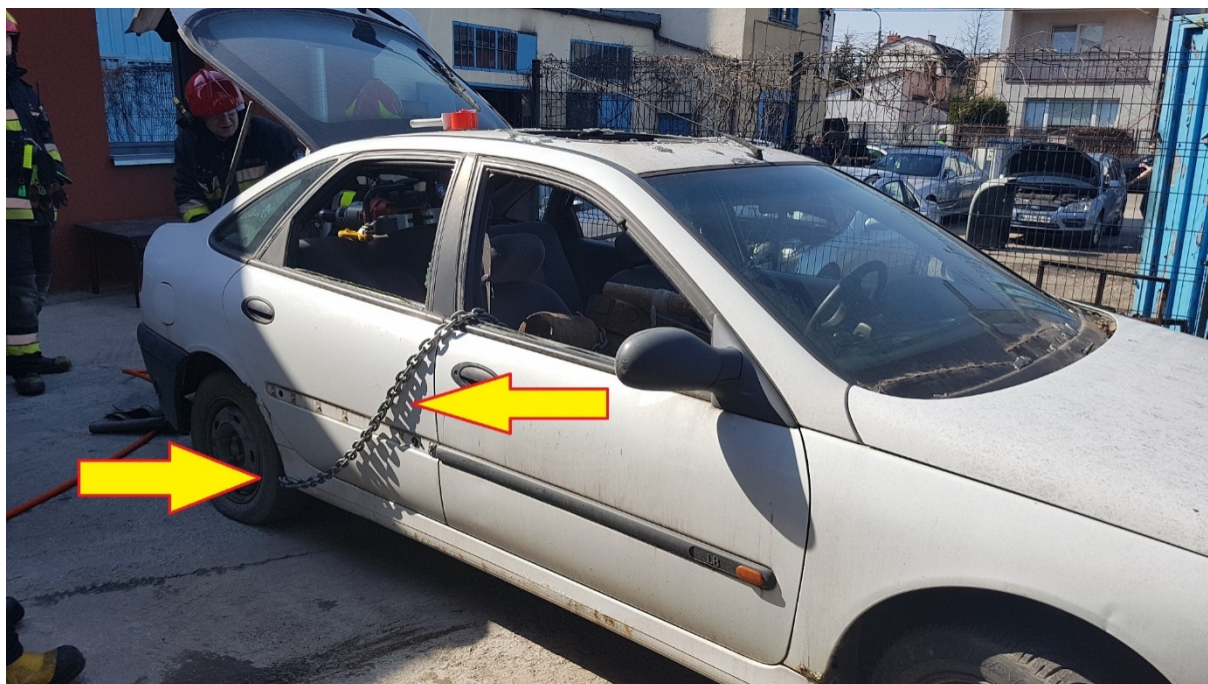
Rys. 468. łańcuch poprowadzony po poszyciu jednego z boków auta i zamontowany na pewnym punkcie u dołu (na całym resorowaniu koła). Ta strona nie jest zgniatana
