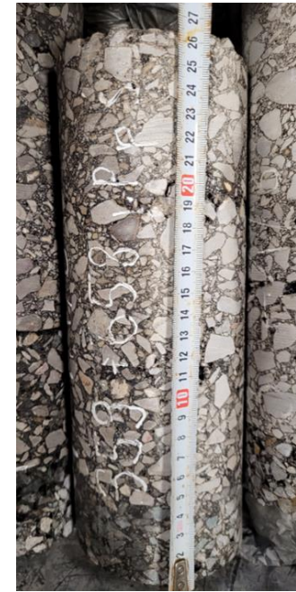
Brak właściwej szczepności, zagęszczenia i grubości na inwestycji A1 odcinek – dojazd do obiektów
