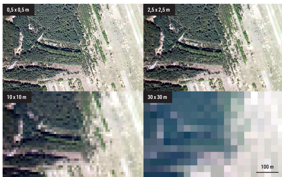
Rysunek 9. Obrazy teledetekcyjne tego samego obszaru o różnej rozdzielczości przestrzennej. W zależności od rozmiaru piksela widzimy więcej lub mniej szczegółów.
