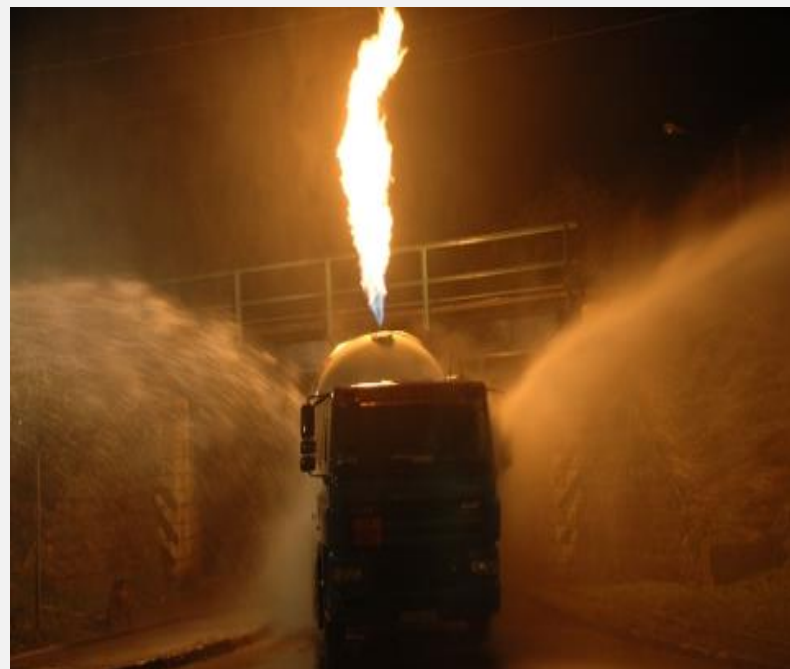
Jet Fire - pożar strumieniowy cysterny w Chrzanowie - akcja ratownicza trwała 25 godzin. Strażacy pozwolili aby gaz się wypalił, w tym czasie schładzano płaszcz zbiornika wodą.
