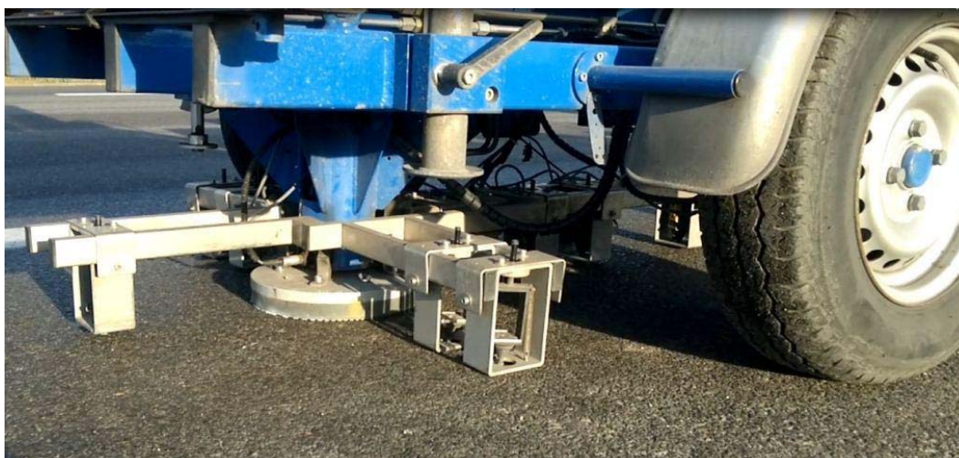
Rysunek 2.8. Aparat FWD podczas pomiaru ugięć nawierzchni
