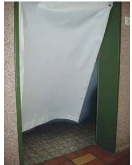
Wpływ urządzenia blokującego dym z kurtyną zakrywającą niemal cały otwór i wymuszającą niski napływ świeżego powietrza na charakter napływu powietrza do pomieszczeń objętych pożarem
