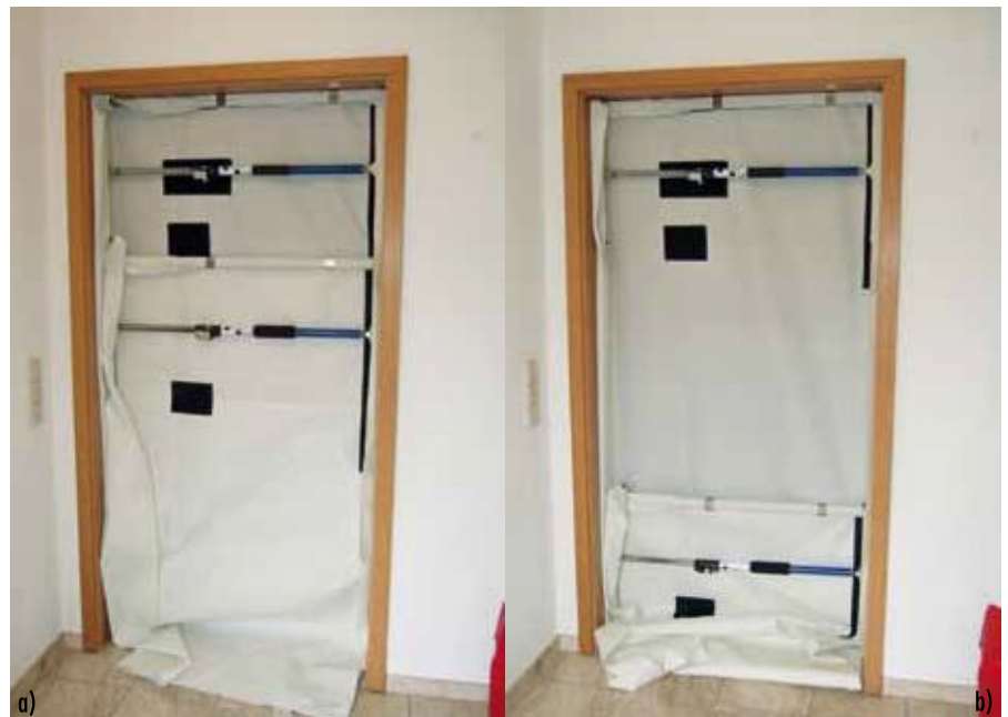
Połączenie dwóch przenośnych urządzeń blokujących dym a) drugie urządzenie jest przymocowane w połowie drzwi; zwiększono poziom zabezpieczenia przed rozprzestrzenianiem się dymu, ale dostęp do pomieszczenia jest nadal możliwy b) drugie urządzenie jest przymocowane w dolnej partii drzwi; rozprzestrzenianie się dymu jest praktycznie niemożliwe, jednak dostęp do pomieszczenia również pozostaje utrudniony
