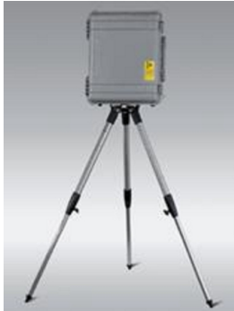
Rys. 1. Walizkowe urządzenie generujące impulsy HPEM (High Power Electromagnetics) typu DS-110 produkcji niemieckiej. Waga 23 kg, natężenie pola elektrycznego w impulsie E = 250 \text{ kV/m} .
