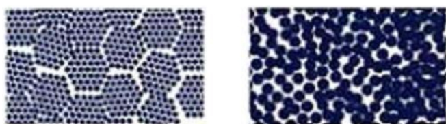
Rys. 5. Porównanie struktury krystalicznej (po lewej) ze strukturą szkła metalicznego (struktura amorficzna – po prawej)
