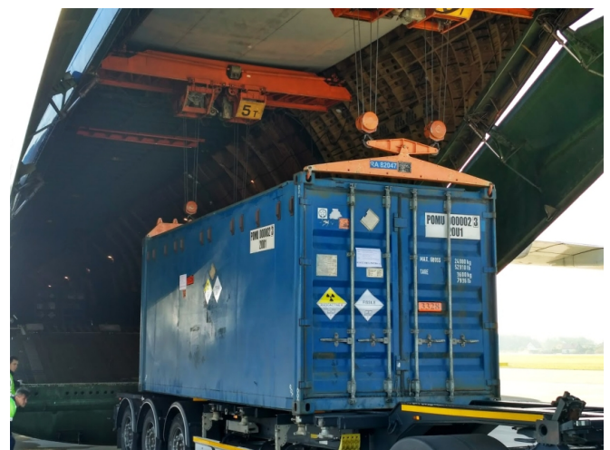
Zdjęcie 1. Poprawnie oznaczony kontener ISO zawierający pojemniki transportowe TUK-19 z wypalonym paliwem jądrowym pochodzącym z reaktora Maria podczas załadunku do samolotu transportowego An-124 (źródło własne).
