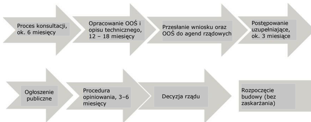
Il. 27 Schematyczny harmonogram procesu badania farmy wiatrowej na obszarze szwedzkiej wyłącznej strefy ekonomicznej.
