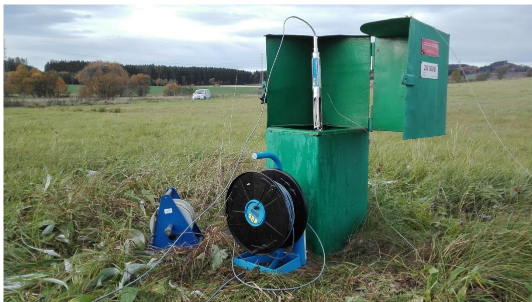
Fig. 7.1 Pomiary terenowe z wykorzystaniem świstawki elektronicznej i multimiernika KLL-Q2 w otworze Grzędę 3P
