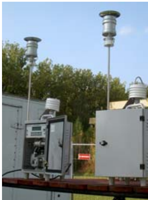
Rys. 3 Zestaw poborników LVS 3DA do pomiarów zawartości rtęci w pyłe PM10 i PM2,5
