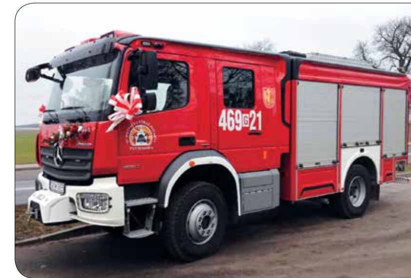
OSP Tychnowy – średni samochód gaśniczy z funkcją ratownictwa technicznego GBART 3/16 Mercedes
