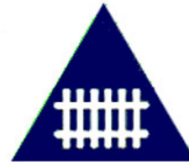
Zamykany przejazd kolejowy
