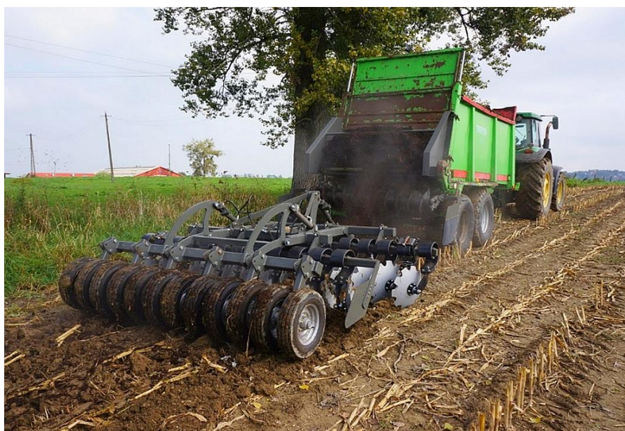
Fot. 14. Modułowy zestaw do aplikacji i bezpośredniego przykrywania obornika
