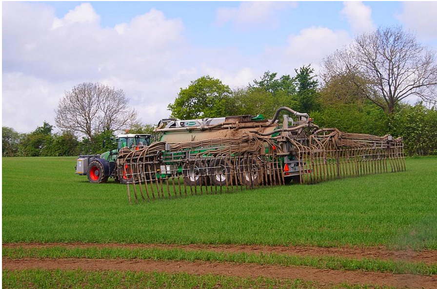
Fot. 13. Zakwaszanie gnojowicy w systemie „in field”
