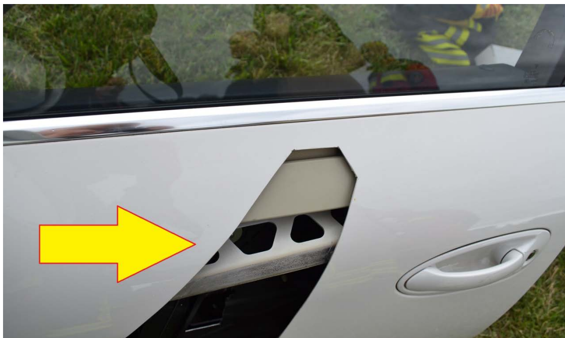
Rys. 135. Widoczne wzmocnienie drzwi
