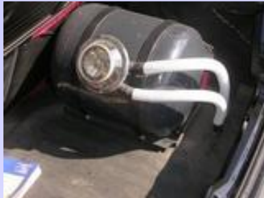
zbiornik o przekroju walcowym w bagażniku
