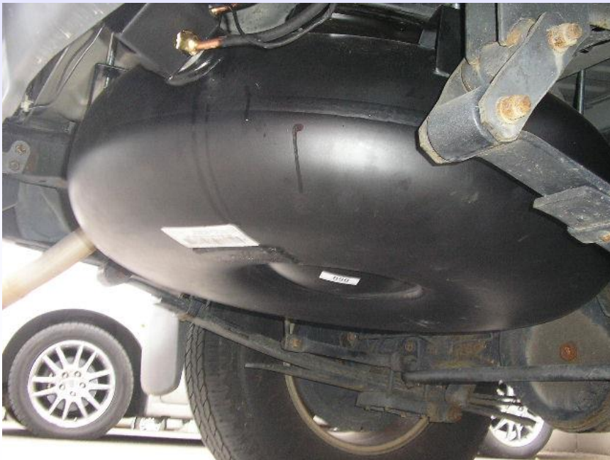
zbiornik o przekroju toroidalnym pod pojazdem
