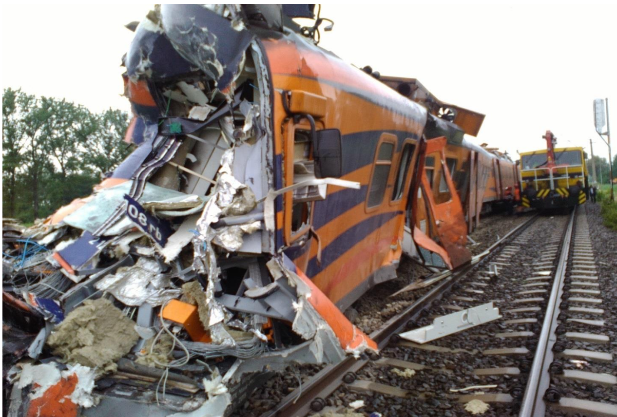
Rysunek 2 - Uszkodzony skład EN 57 AL - 2108”B” po zdarzeniu
