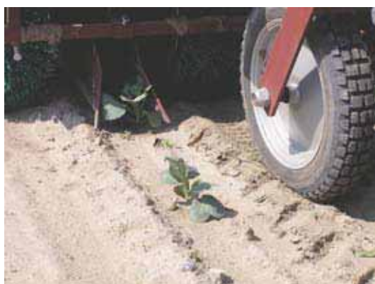
Rys. 3 Osłony roślin w pielniku szczotkowym skutecznie zapobiegają zasypaniu roślin
