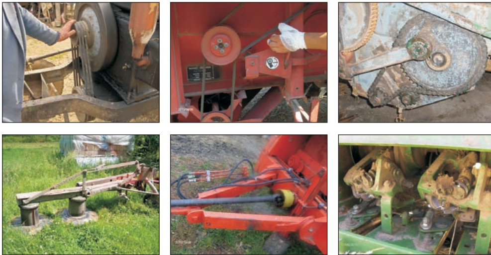
Brak osłon ruchomych części maszyn i urządzeń (fot. OR Lublin, OR Rzeszów, OR Olsztyn, OR Kraków i OR Warszawa)
