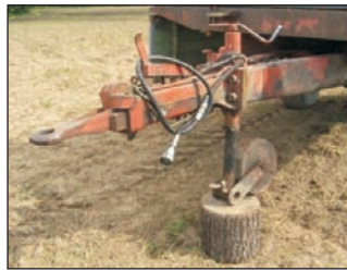
Nieodpowiednie magazynowanie drewna i zabezpieczenie maszyn podczas postoju (fot. OR Wrocław, OR Białystok i OR Olsztyn)
