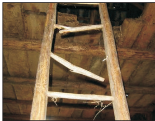
Niewłaściwa konstrukcja i zły stan techniczny drabin (fot. OR Koszalin, OR Kraków i OR Warszawa)
