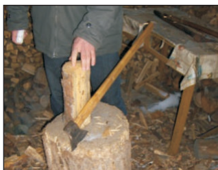
Niewłaściwe przechowywanie lub trzymanie ostrych przedmiotów, niewłaściwe uchwycenie i trzymanie narzędzi oraz brak ochron osobistych (fot. OR Bydgoszcz i OR Lublin)
