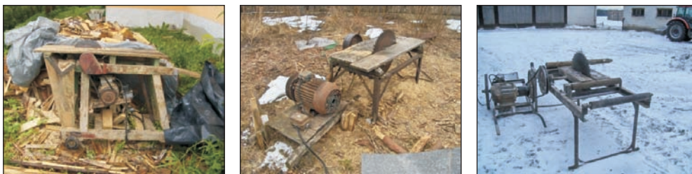
Balagan, śliska nawierzchnia w miejscu pracy i nieosłonięte ostre i ruchome części pilarek tarczowych (fot. OR Rzeszów i OR Warszawa)
