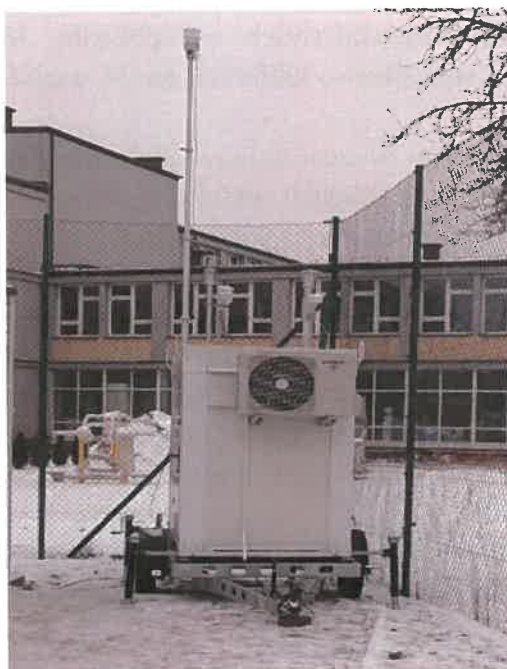
Fot.3 Mobilna stacja monitoringu powietrza na terenie Zespołu Szkół przy ul. Z. Kazikowskiego w Mińsku Mazowieckim
