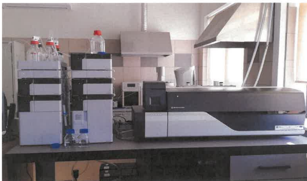
Fot.1 Chromatograf cieczowy z tandemową spektrometrią mas LC-MS/MS do oznaczeń związków wielkocząsteczkowych w monitoringu
