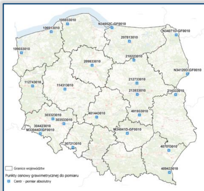
Rysunek 4. Rozmieszczenie punktów osnowy grawimetrycznej klasy fundamentalnej pomierzonych w 2024 r.
