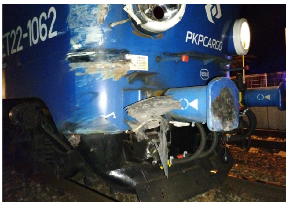
Zdjęcie 10 – Uszkodzenia lokomotywy ET22-1062 (material komisji kolejowej)
