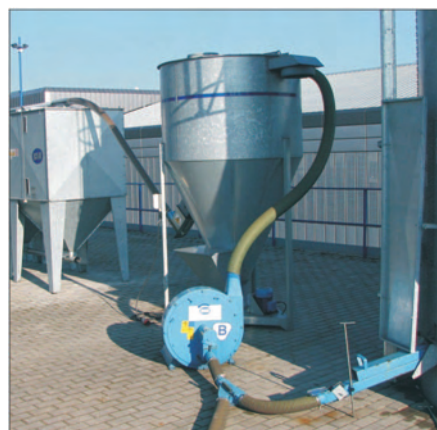
Zezwolenie nr 56/2008 Rozdrabniacz bijakowy ssąco-tłoczący do ziarna H 965/1, stanowiący element linii paszowej H 203 producent „BIN” Spółka z o.o. w Aleksandrowie Kujawskim
