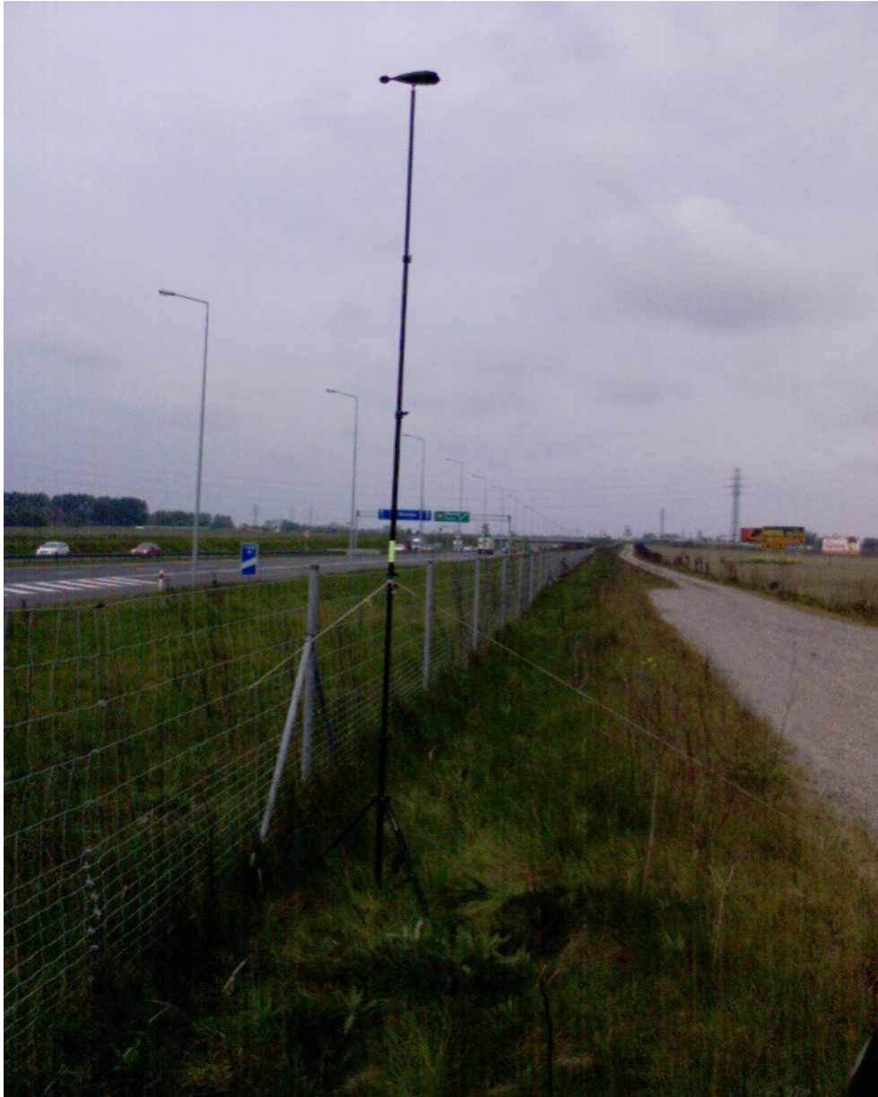
Rys.57- pomiar hałasu drogowego A4-Chorzów-Sośnica
