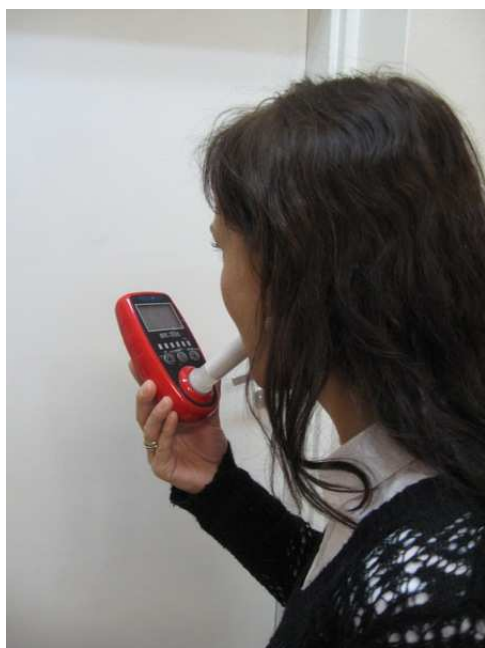
Pomiar tlenku węgla w wydychanym powietrzu przy użyciu smokerlyzera
