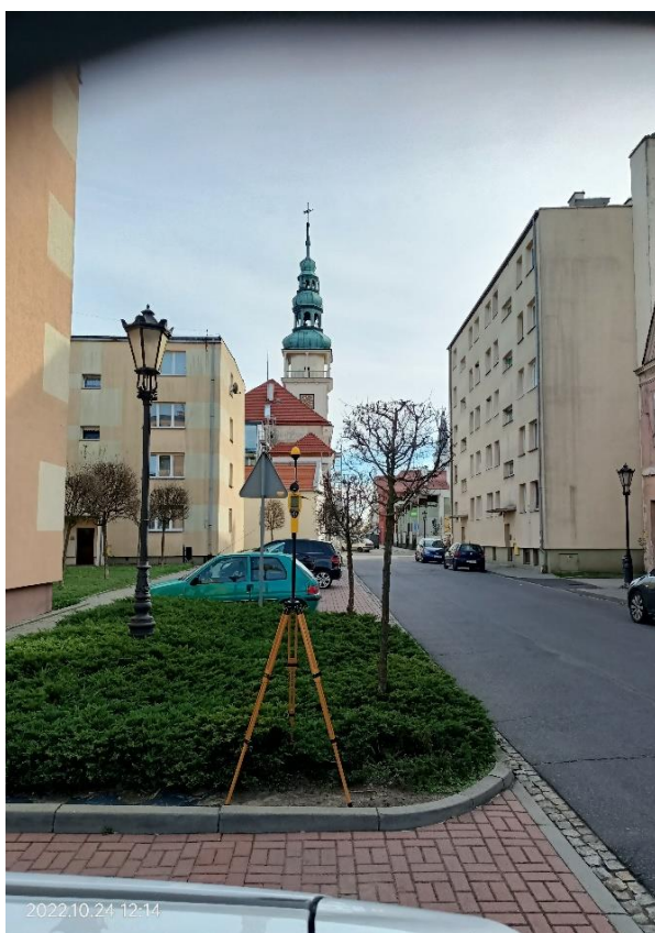
Fotografia 2.1. – 2.2. Pomiar pól elektromagnetycznych miernikiem Narda NBM-550 (źródło: CLB Oddział w Zielonej Górze)
