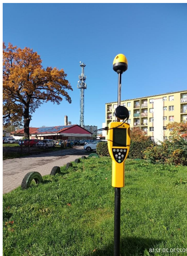
Fotografia 2.1. – 2.2. Pomiar pól elektromagnetycznych miernikiem Narda NBM-550 (źródło: CLB Oddział w Zielonej Górze)
