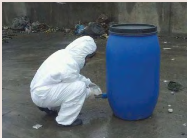
Pomiar rozkładu mocy dawki wokół wydzielonych odpadów
