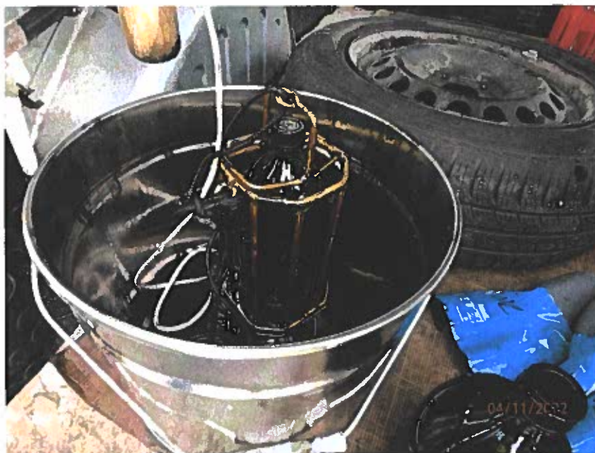
Zdjęcie 33. Próbник typu „butelka w koszu” służący do poboru oleju z cysterny
