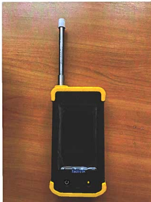
Zdjęcie 86. Przenośny spektrometr Ramana do badań substancji nieznanego pochodzenia TacticID Mobile
