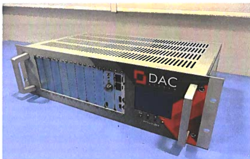
Zdjęcie 84. System zbierania danych DAS- Datalogger DACSYSTEM Enviro DAS DM370
