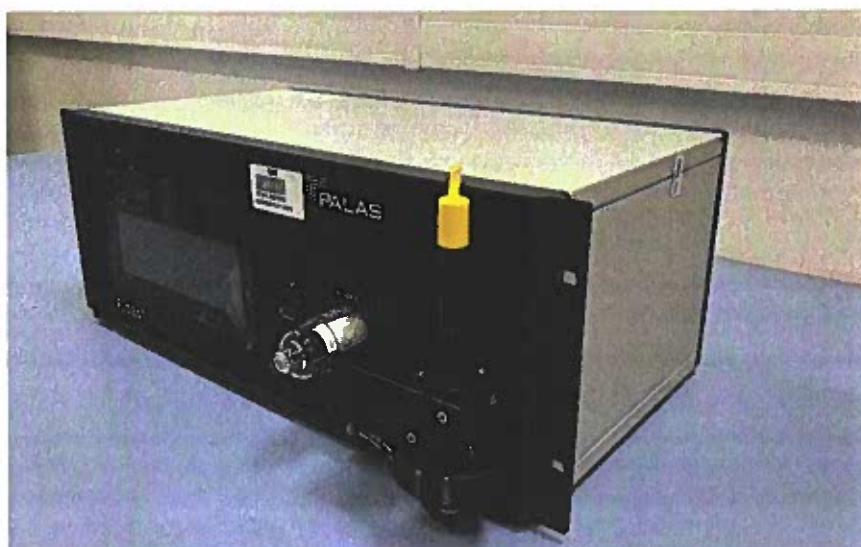
Zdjęcie 81. Automatyczny analizator do pomiaru stężeń pyłu zawieszonego PM10/ PM2,5 FIDAS200 PALAS GmbH
