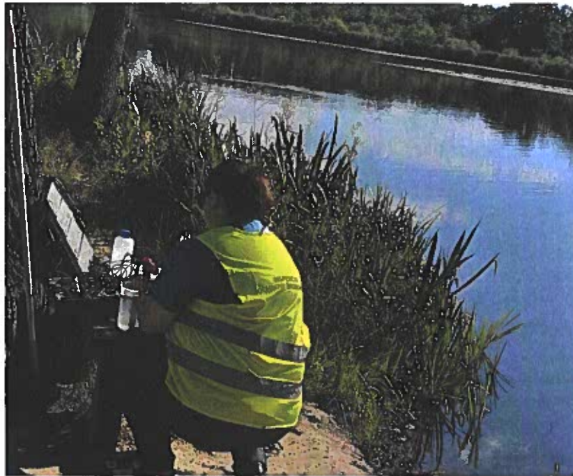
Zdjęcie 3. Badania wstępne próbki wody za pomocą przyrządu wielofunkcyjnego Multimetr Elmetron ze stawu w Tułowicach
