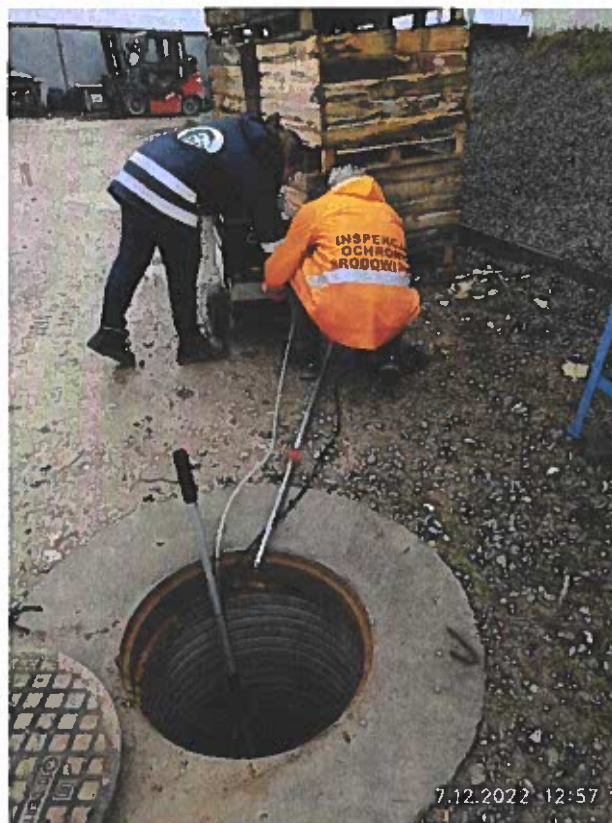
Zdjęcie 4. Kontrola z wykorzystaniem przenośnego automatu do poboru próbki średniodobowej ścieków
