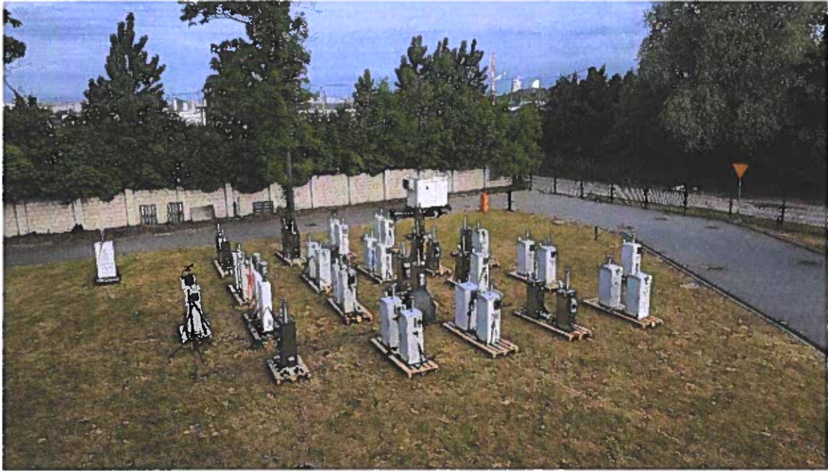
Zdjęcie 73. Międzylaboratoryjne badania porównawcze pyłu zawieszonego PM10 i PM2.5 oraz oznaczania metali ciężkich i benzo(a)pirenu w pyłe zawieszonym PM10 organizowane przez KLRP w roku 2022
