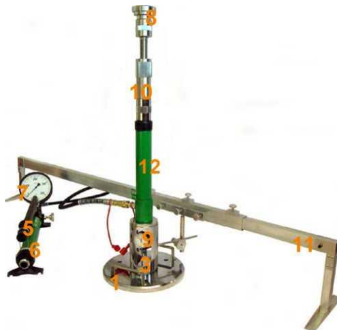
Rys. 1.2 Aparatura VSS z jednopunktowym pomiarem przemieszczenia płyty
