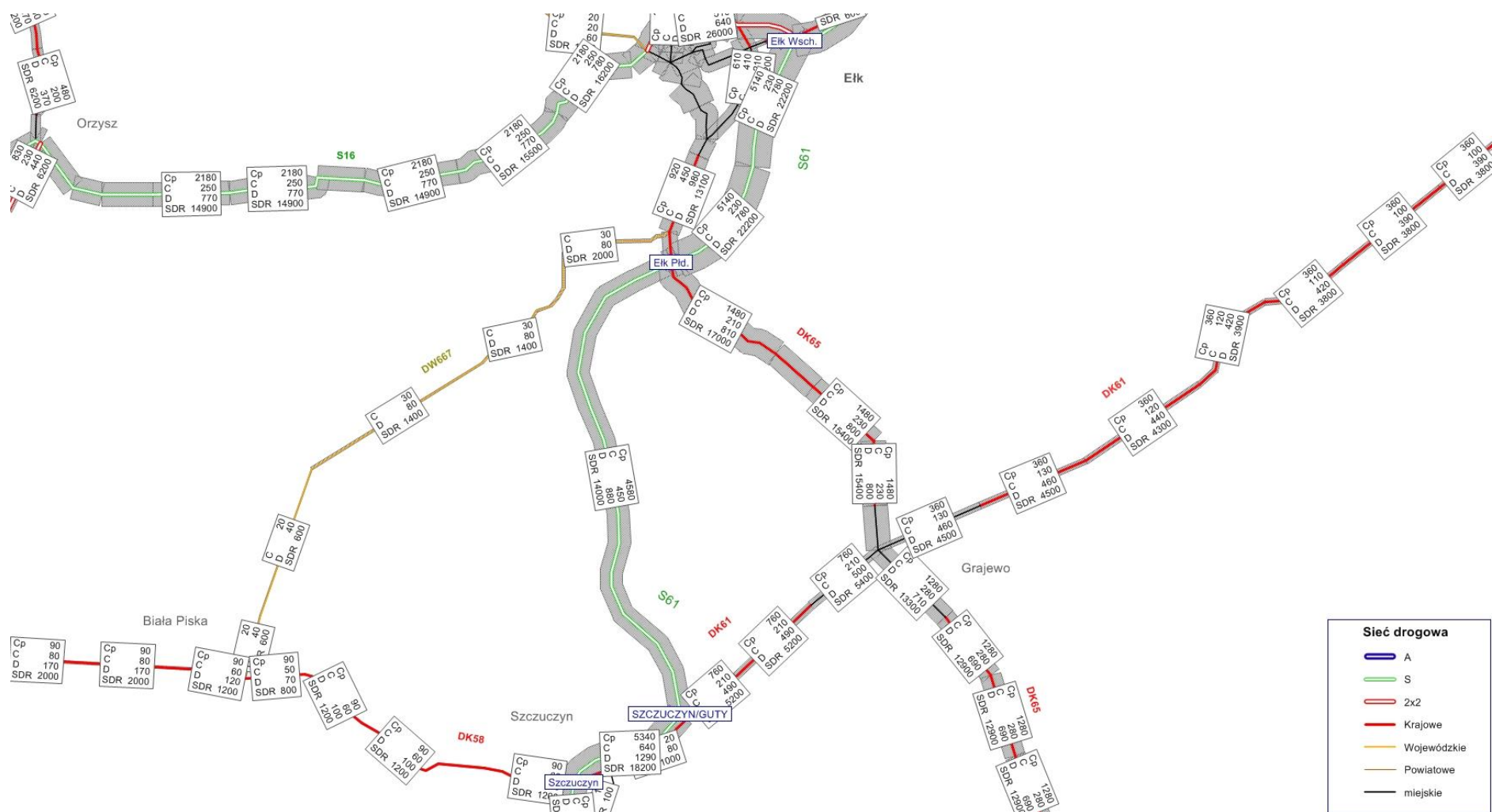
Rysunek 9.17 Natężenie pojazdów SDR [poj./dobę] w roku 2040, odcinek Elk - Szczuczyn - wariant inwestycyjny
