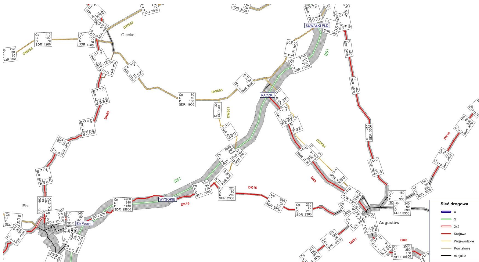
Rysunek 9.8 Natężenie pojazdów SDR [poj./dobę] w roku 2025, odcinek Suwałki - Ełk - wariant inwestycyjny
