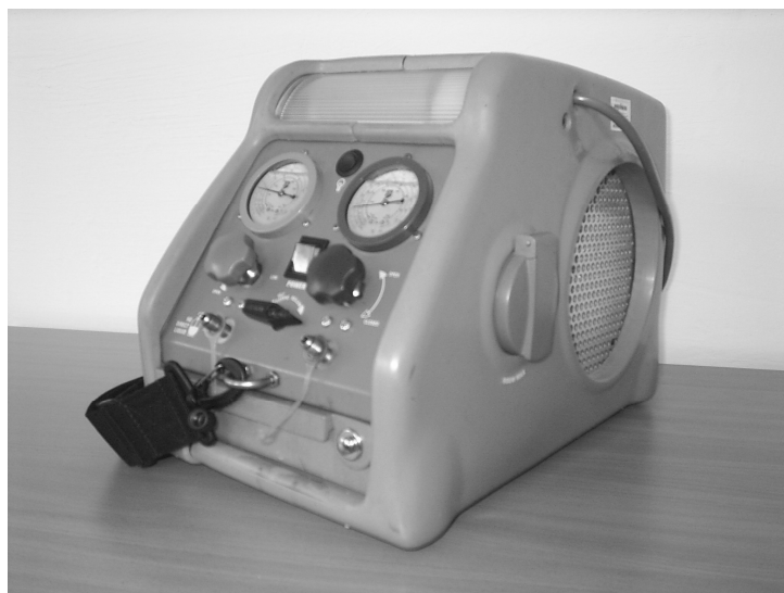
Rys. 9.1. Stacja odzysku czynników chłodniczych firmy Eco Buddy.
