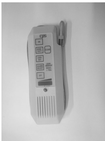
Rys. 7.4. Podręczne urządzenie do wykrywania nieszczelności w instalacjach i urządzeniach chłodniczych firmy CPS.
