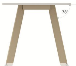
rys. 2 – kąt pochylenia nogi w stosunku do blatu
