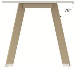
rys. 2 – kąt pochylenia nogi w stosunku do blatu
