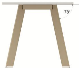
rys. 2 – kąt pochylenia nogi w stosunku do blatu
