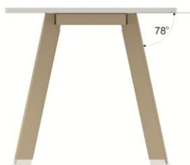
rys. 2 – kąt pochylenia nogi w stosunku do blatu
