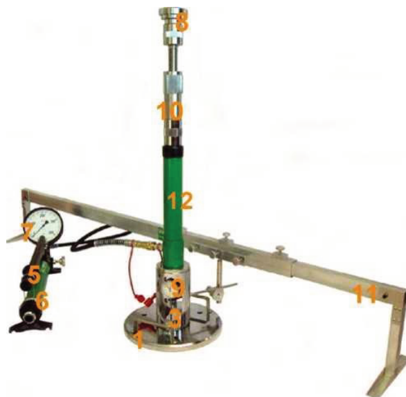
Rys. 1.2. Aparatura VSS z jednopunktowym pomiarem przemieszczenia płyty
