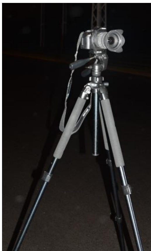
Rys. 1.3 Przykładowy miernik matrycowy do pomiaru luminancji typu CCD wraz ze statywem umożliwiającym precyzyjne ustawienie zadanej geometrii pomiaru
