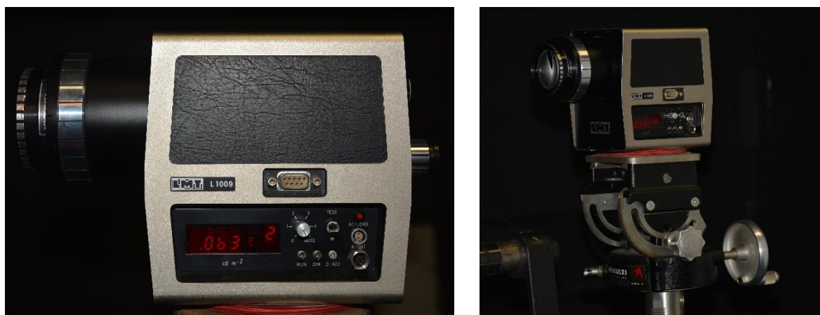
Rys. 1.4 Widok punkowego miernika luminancji o kątach fotometrowania od 6' do 3°
