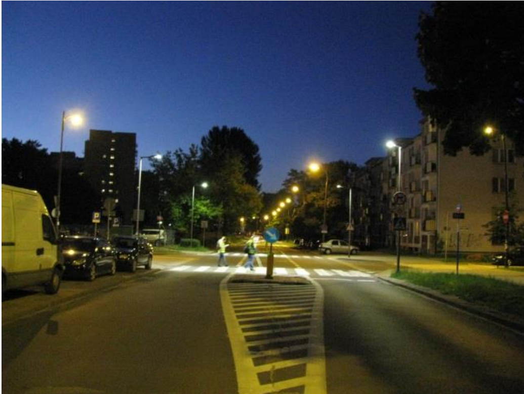
Rys. 10.24 Zmiana wysokości zawieszenia opraw oświetleniowych – przykład 2
