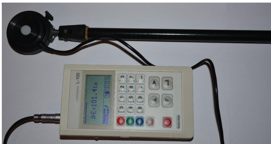
Rys. 1.6 Widok luksomierza z możliwością rejestracji wyników, klasa A, ogniwo selenowe płaskie, drążek pomiarowy do mocowania ogniwa, Firma 2
