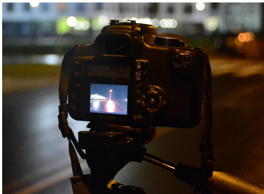
Rys. 1.2 Przykładowy miernik matrycowy do pomiaru luminancji typu CCD
