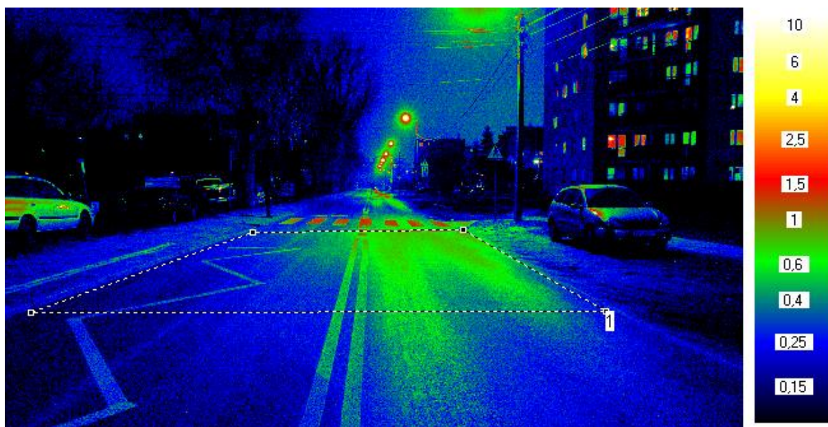
Rys. 3.6 Pomiar rozkładu luminancji przed przejściem z wykorzystaniem miernika matrycowego (droga dwukierunkowa o jednym pasie ruchu w każdym kierunku, kierunek 1)
