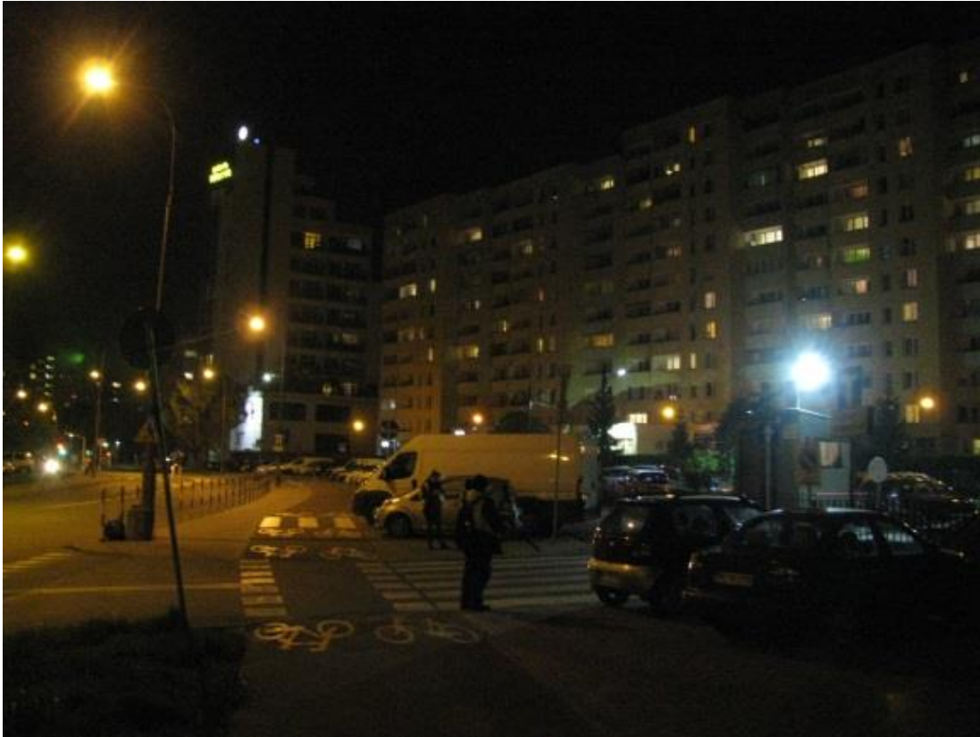
Rys. 10.47 Problem oślnienia w otoczeniu przejścia dla pieszych – przykład 2
