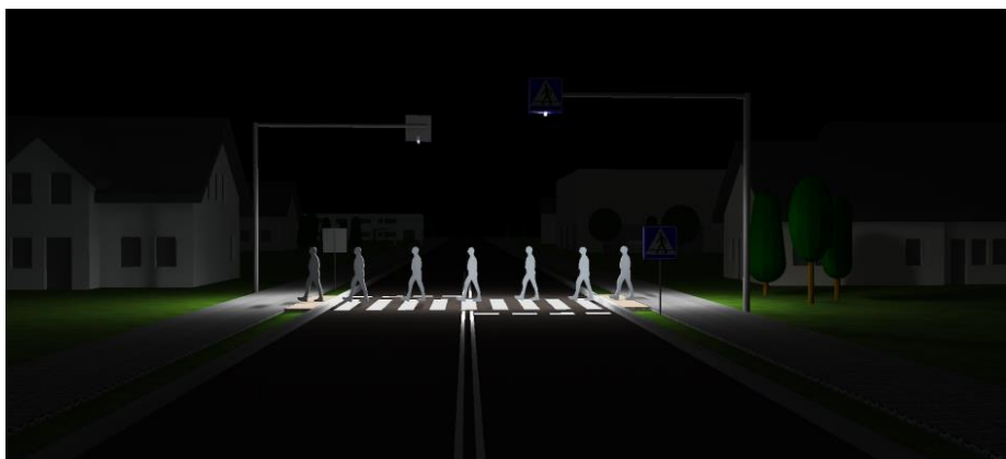
Rys. 10.89 Propozycja doświetlenia przejścia dla pieszych na drogach o dwóch kierunkach ruchu – widok z perspektywy kierowcy
