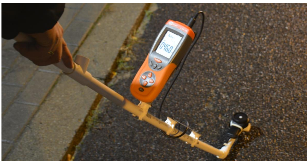
Rys. 1.5 Widok luksomierza z możliwością rejestracji wyników, klasa A, ogniwo selenowe płaskie, drążek pomiarowy do mocowania ogniwa, Firma 1
