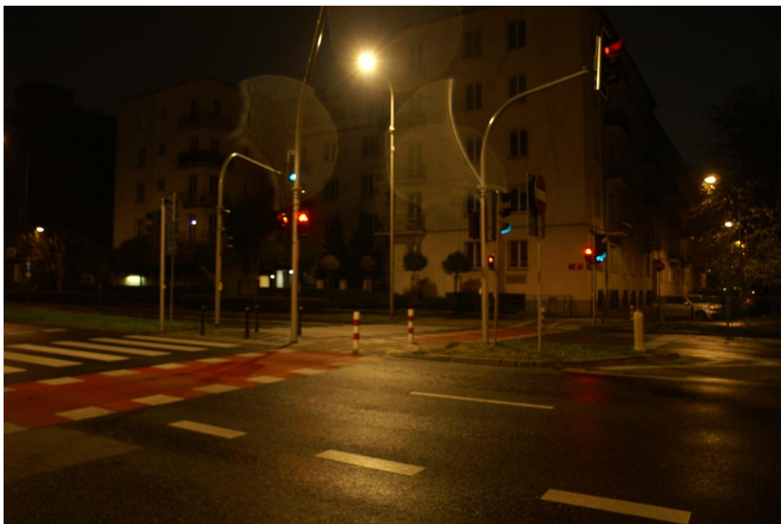
Rys. 9.89 Widok przejścia dla pieszych. Widoczna oprawa sodowa wysokoprężna położona najbliżej przejścia dla pieszych
