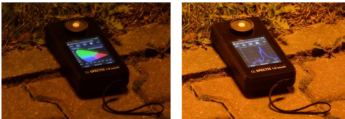
Rys. 1.7 Spektrometr przenośny do pomiaru parametrów barwowych i widma promieniowania
