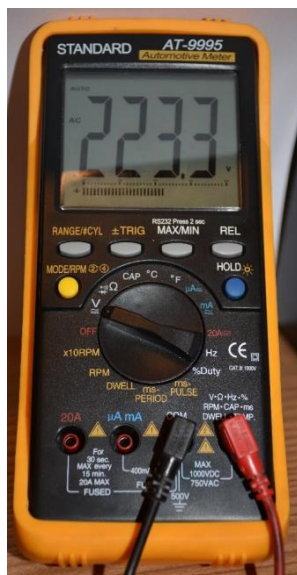
Rys. 1.9 Multimetr cyfrowy do pomiaru parametrów elektrycznych instalacji zasilającej oprawy oświetleniowe
