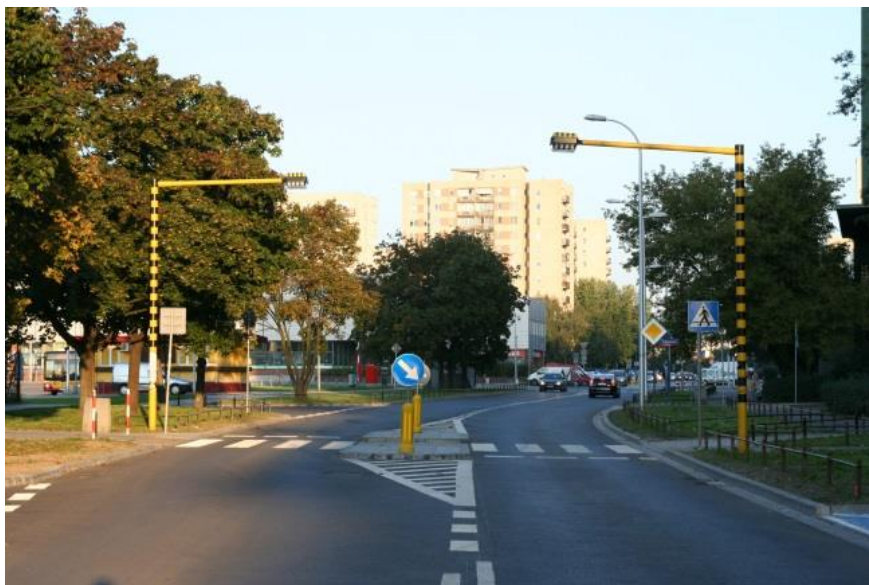
Rys. 10.5 Zastosowanie charakterystycznej konstrukcji słupa i jego malowania - przykład 1a
