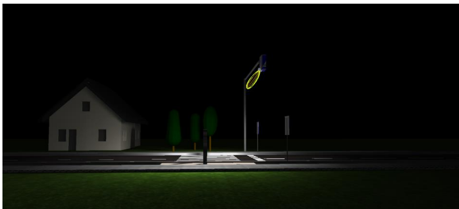
Rys. 10.93 Propozycja doświetlenia przejścia dla pieszych na drogach o jednym kierunku ruchu – widok z perspektywy pieszego
