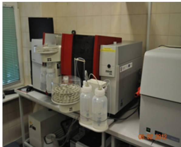
Rys. 7.5. Spektrometr absorpcji atomowej z kuwetą grafitową zainstalowany w Laboratorium WIOŚ w Szczecinie
