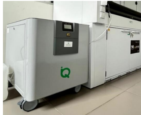
Zdjęcie 47. Generator azotu
