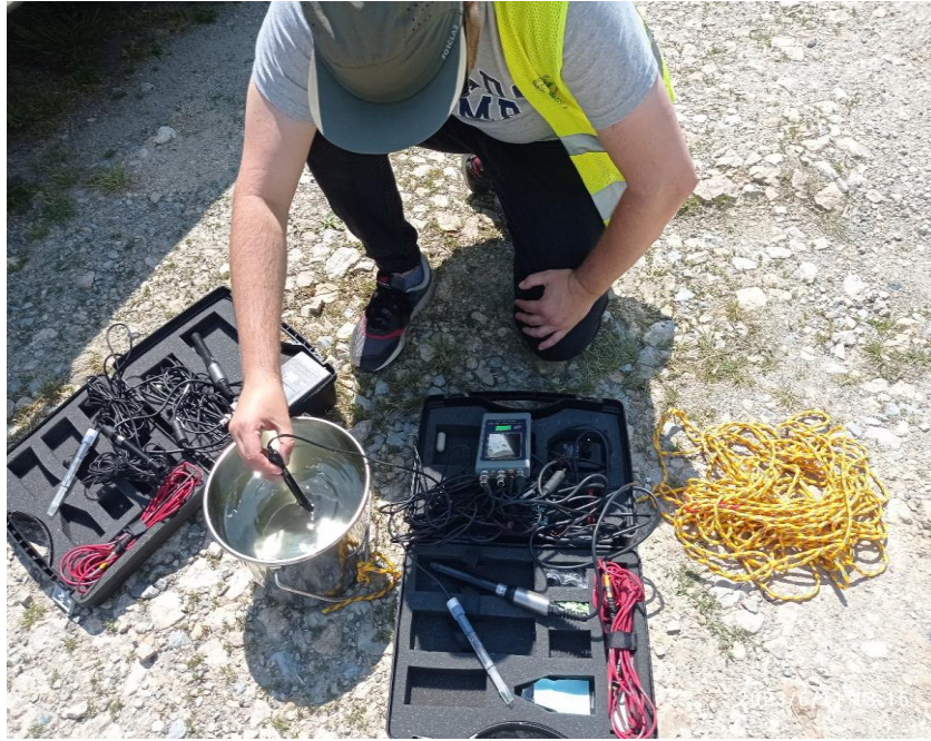
Zdjęcie 1. Badania wstępne próby wody z Kanału Gliwickiego za pomocą przyrządu wielofunkcyjnego do terenowych pomiarów wody
