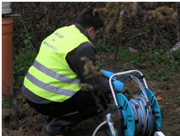
Fot. 23. Pobór próbek wody podziemnej z piezometru zlokalizowanego na terenie zlikwidowanego mogilnika w Zajezerzu
