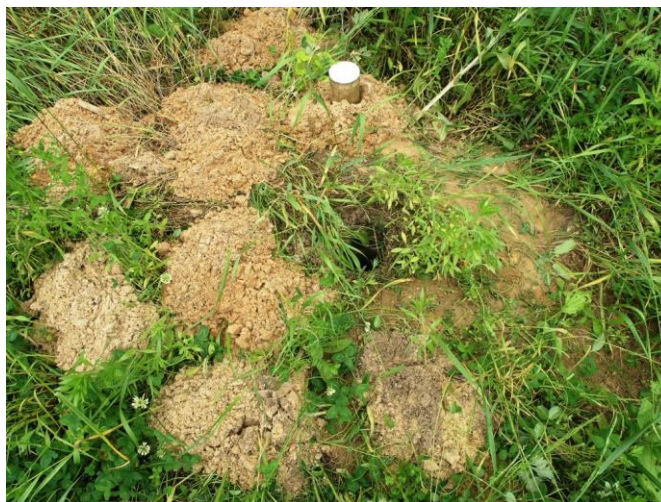
Fot. 24. Otwór badawczy oraz próbki gruntu pobrane powyżej warstwy badanej
