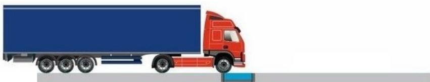
Rys. 2. Wymagane ułożenie wag podczas ważenia pojazdu (wszystkie koła na tej samej wysokości).
