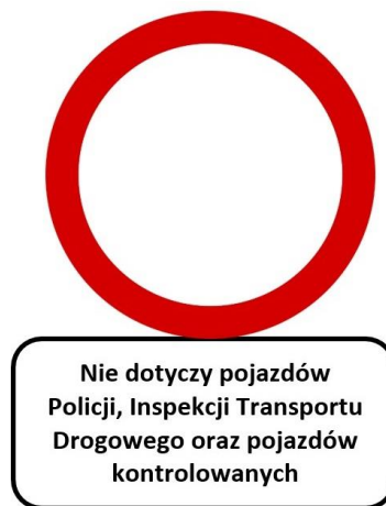
Rys. 12. Oznakowanie drogi wjazdowej i wyjazdowej znakiem B-1 i tabliczką uzupełniającą.
