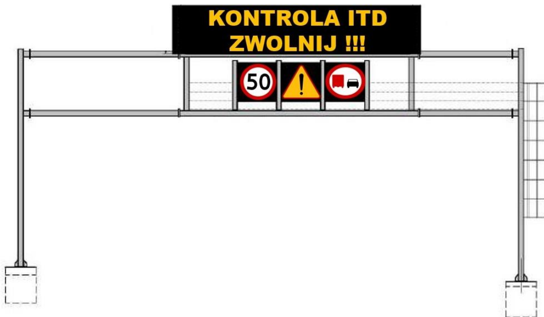
Rys. 7. Tablica z informacją o prowadzonych działaniach kontrolnych.
