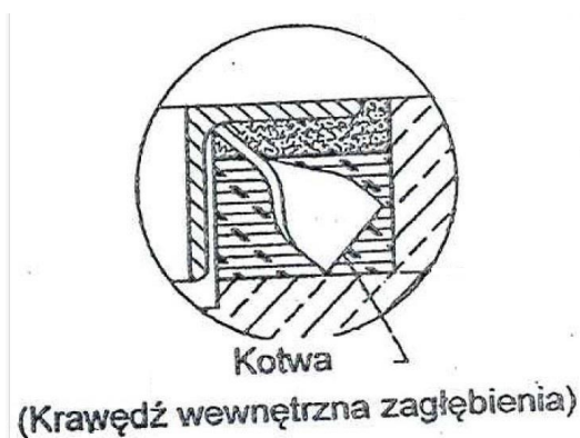
Rys. 3. Przytwierdzenie kątownika zabezpieczającego krawędzie wnęki wagowej.
