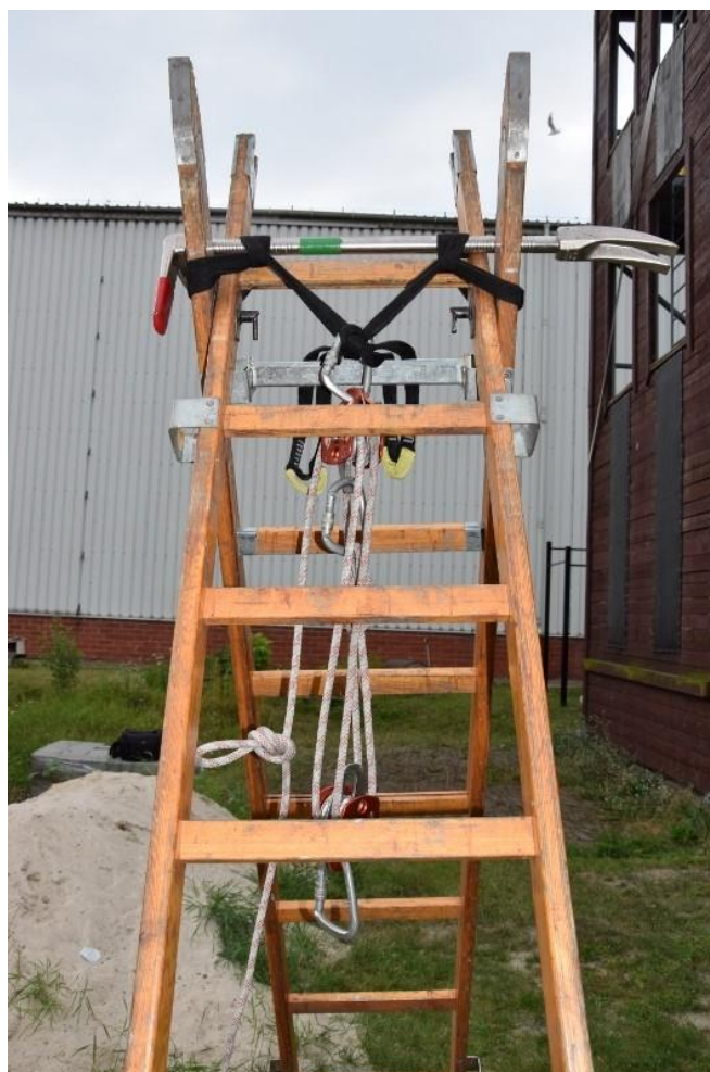
Rys. 58). Trójnoż ratowniczy „zastępczy” w układzie 1 : 4
