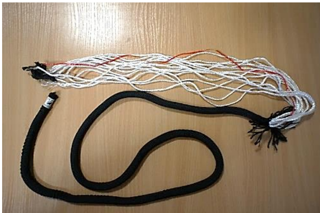
Rys. 9). Budowa liny alpinistycznej
