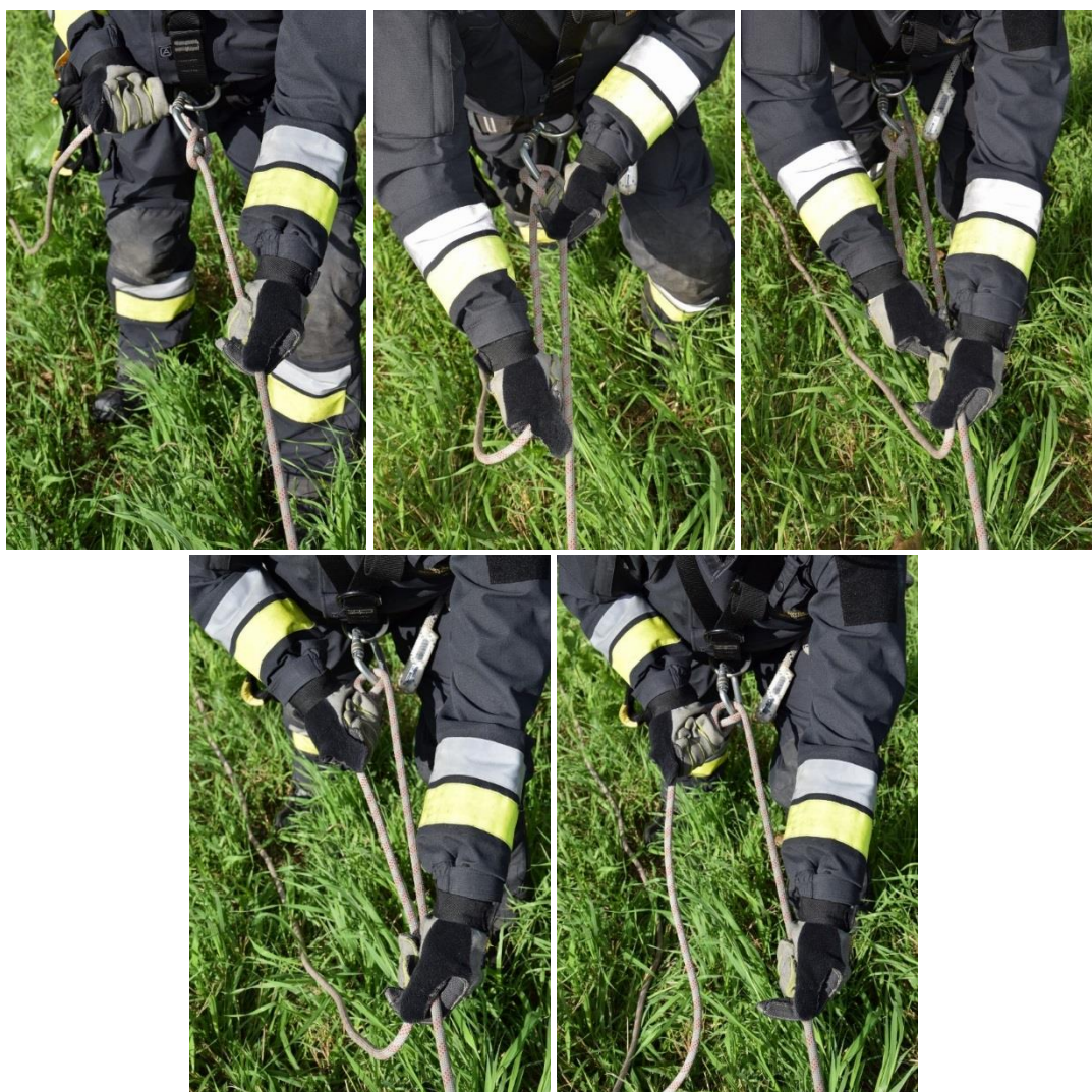
Rys. 35). Poruszanie się po powierzchni pochyłej na półwyblince
