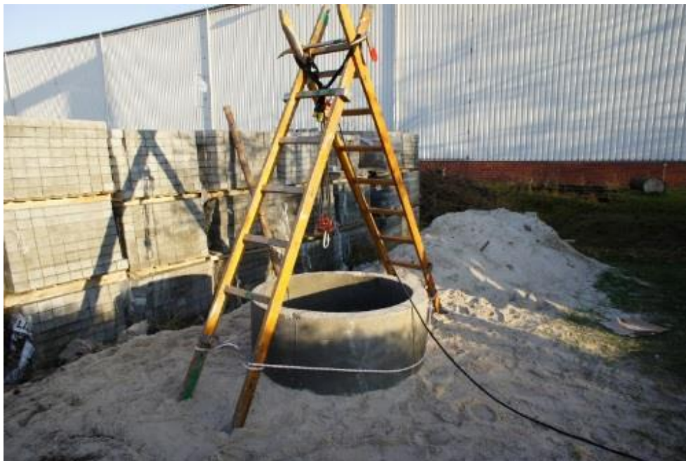
Rys. 13). Trójnóg ratowniczy z drabin DN 2,4
