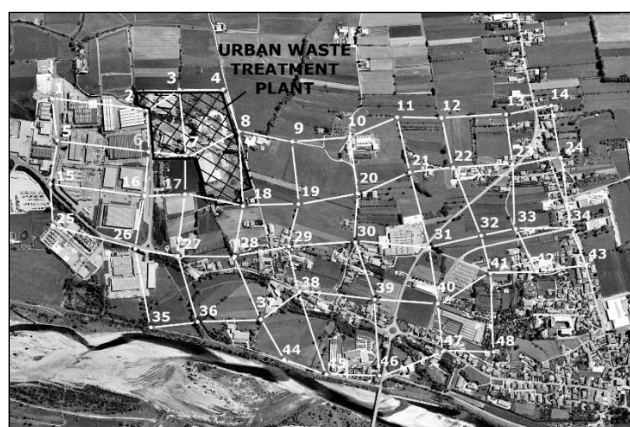
Rysunek 2. Przykład rozmieszczenia siatki pomiarowej ustalonej wokół komunalnej oczyszczalni ścieków 121
