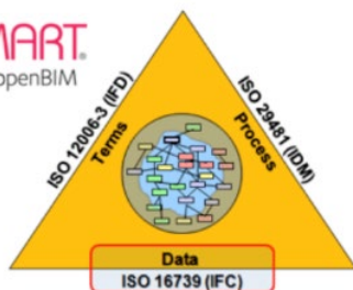
Rysunek 56: Struktura formatu, słownika i metod wymiany informacji w środowisku Open BIM. 155
