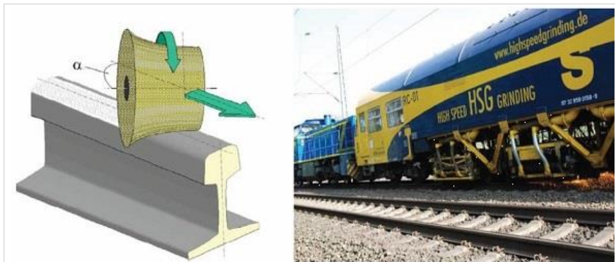
Rysunek 21 Szlifowanie szyn metodą HSG - High Speed Grinding
