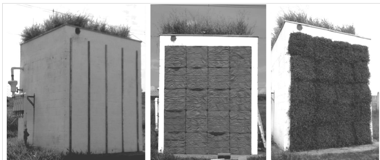
Rysunek 45 Zielone ściany (green walls) o wysokim współczynniku pochłaniania jako rozwiązanie redukujące hałas w kanionach ulicznych
