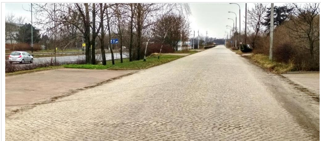
Rysunek 12 Przykład drogi o nawierzchni z kostki brukowej. Emisja hałasu pojazdu poruszającego się po tego rodzaju nawierzchni jest większa o ok. 3 dB względem ruchu na asfaltobetonie przy zachowaniu tej samej prędkości (dane na podstawie CNOSSOS-EU, zdjęcie – materiały własne)
