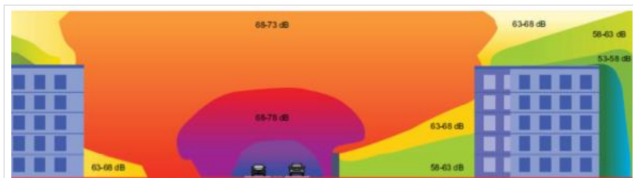
Rysunek 33 Przykład propagacji hałasu drogowego (10 000 przejazdów/dzień ze średnią prędkością 50 km/h) w sąsiedztwie zabudowy o wys. 20 m - zasięg hałasu przy obecności ekranu o wys. 3 m - po prawej, bez ekranu - po lewej (źródło: CEDR Call 2012: Noise; ON-AIR Optimised Noise Assessment and Management Guidance for National Roads; Investigation of noise planning procedures and tools, 2015)
