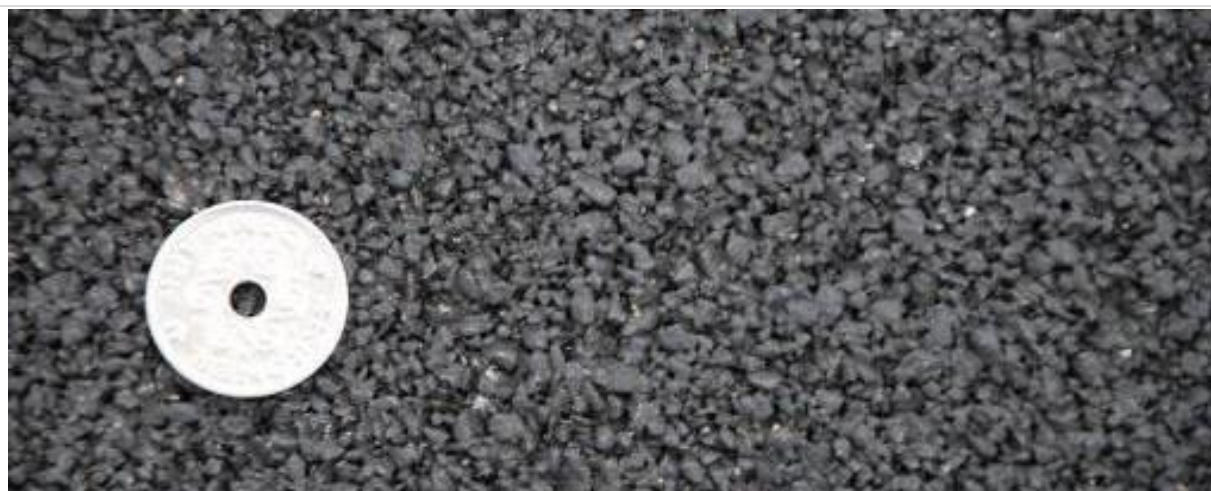
Rysunek 11 Struktura nawierzchni jednowarstwowej (źródło: DVS-DRI Super Quiet Traffic International search for pavement providing 10 dB noise reduction, Danish Road Institute Report nr 178, 2009)
