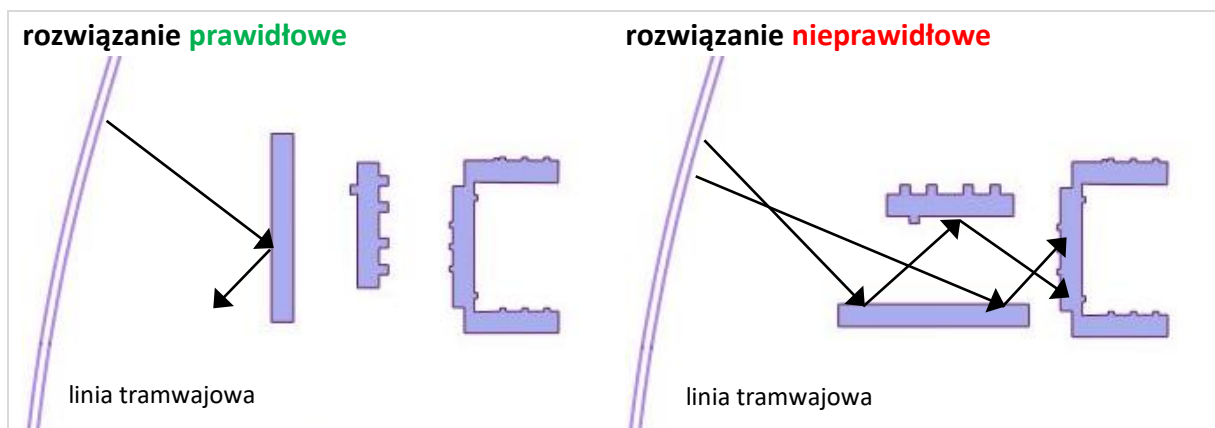
Rysunek 52 Prawidłowe i nieprawidłowe orientacje budynków zlokalizowanych w pobliżu linii tramwajowej, ze względu na wymagania akustyczne (opracowanie własne)
